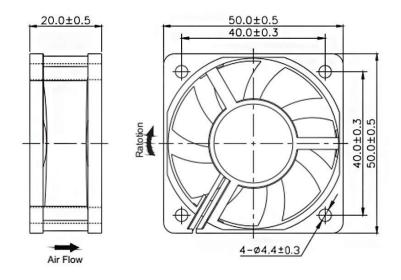
Frame: Plastic(UL:94V-0) Impeller: Plastic(UL:94V-0) Lead wire: UL 1007AWG24
